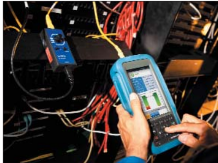
Bild 2: Auf der Suche nach physikalischen Störungen – mit dem MaxTester 635 kann sichergestellt werden, ob ein gewünschtes Rauschminderungsverfahren wirklich einsetzbar ist
